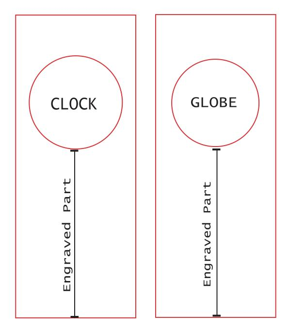
FORNT PANEL LEFT CLOCK DIA: 2" DISTANCE BETWEEN CLOCK AND THE BOTTOM: 3.625" BACK PANEL LEFT GLOBE DIA: 1.875" DISTANCE BETWEEN CLOCK AND THE BOTTOM: 3.625"
